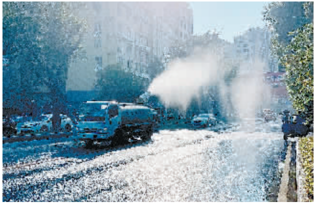
洒水车日常喷淋降尘,提高道路周边空气质量。
